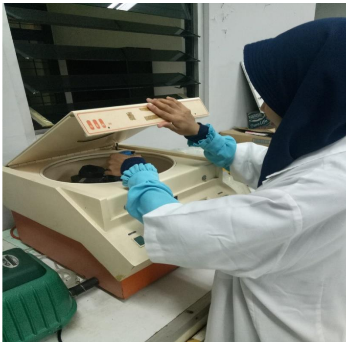
Gambar 6. Proses pemisahan endapan spora menggunakan tabung sentrifus
